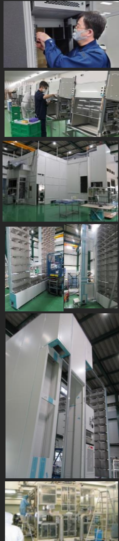
サーバ・クリーン機器・サマルチャンバースWトッカーの製造組立支援作業
